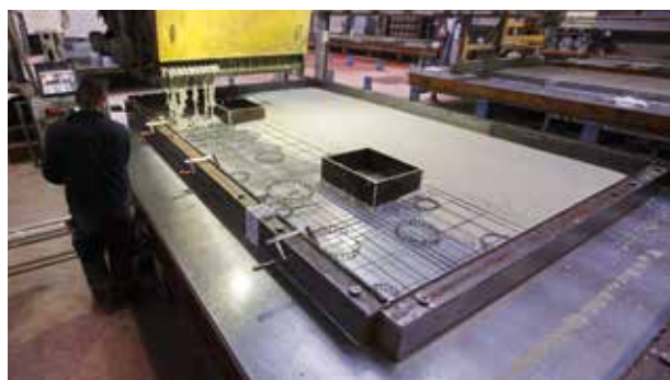
Stap 2: Eerste betonschil van de sandwichwand wordt gestort.
