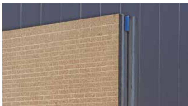
Stap 6: In de kern geïsoleerde sandwichwand is klaar voor transport naar de bouwplaats.
