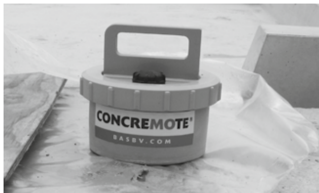
Geplaatst Concremote® systeem
