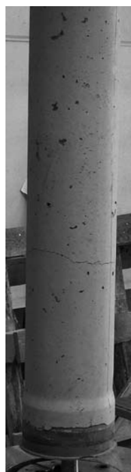
Eerste scheur (150 N/mm 2 )
